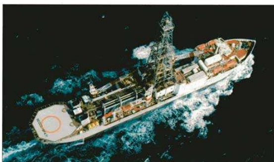
Figura TECPLA-25 El IOIDES Resolution, el buque para realizar sondeos del Ocean Drilling Program. Este moderno buque perforador ha sustituido al Glomar Challenger en el importante trabajo de tomar muestras de los fondos de los océanos mundiales. (Foto cortesía del Ocean Drilling Program.)
